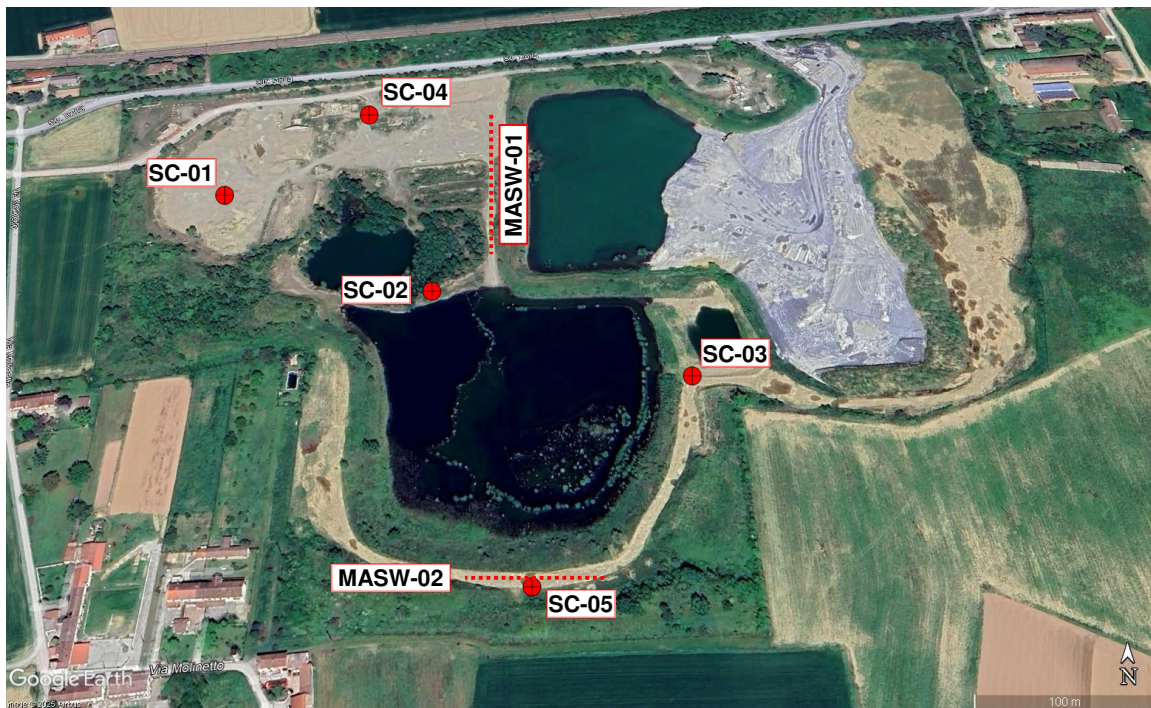
Figura 3. Posizione planimetrica dei sondaggi geotecnici e delle prove sismiche MASW eseguite nella recente indagine geotecnica del 2025.
